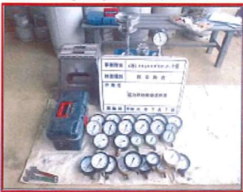
◆安定的に既知の値を示す基準器を用いて測定。測定具が示す読み値が、期待する値から大きく外れていないか検査。
