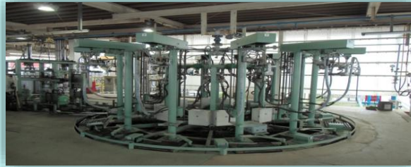
12連式回転充填機 3周 9分でトラック1台分の充填可能
