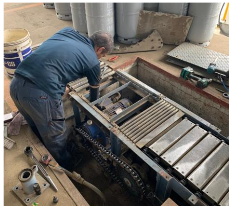
スラットコンベア調整中
