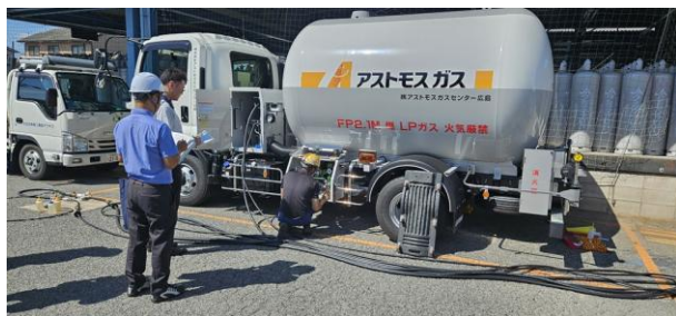
バルクローリーの完成検査の様子
