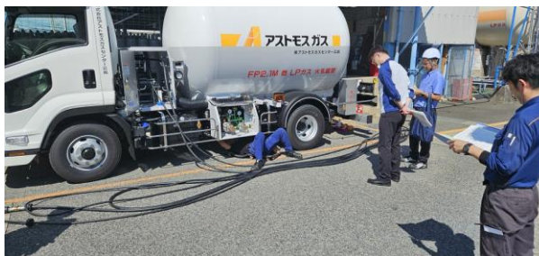
バルクローリーの完成検査の様子
