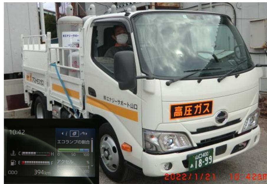
これにより50K容器の落下防止と20K容器の積み降ろし作業に支障がでないよう工夫しております。□
